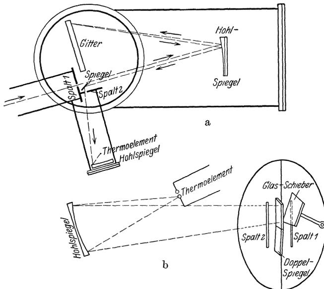
Abb. 24 a und b. Gitter-Spiegelspektrometer nach BADGER.
