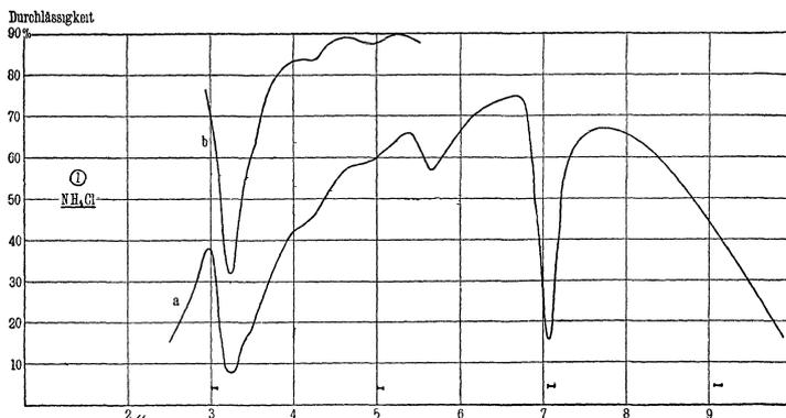
Abb. 138 b. Durchlässigkeit von  $\text{NH}_4\text{Cl}$  nach REINKOBER.
