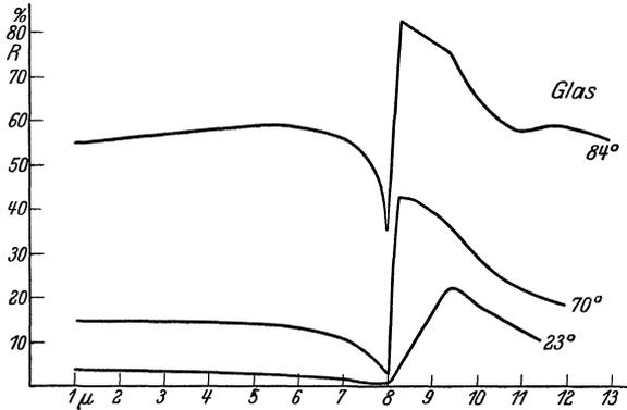
Abb. 75. Abhängigkeit der reflektierten Energie vom Einfallswinkel bei Glas.
