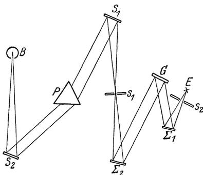
Abb. 26. Anordnung zu Dispersionsmessungen nach PASCHEN.
