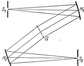
Abb. 19. Gitter-Spiegelspektrometer.
