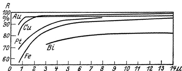
Abb. 60. Reflexionsvermögen einiger Metalle nach HAGEN und RUBENS.
