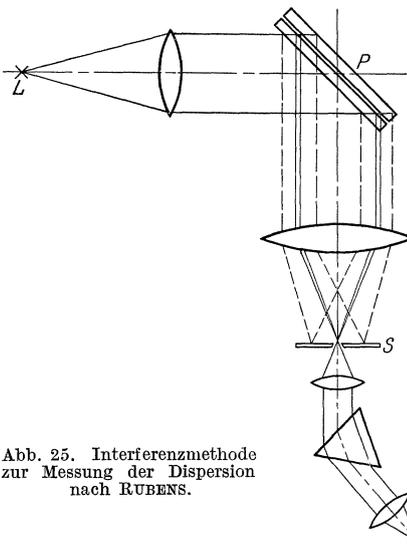
Abb. 25. Interferenzmethode zur Messung der Dispersion nach RUBENS.
