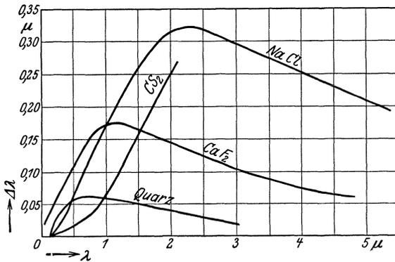
Abb. 27. Dispersion von Steinsalz, Schwefelkohlenstoff, Flußspat und Quarz.
