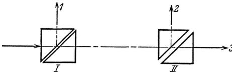
Abb. 40. Totalreflexionsmethode zur Isolierung langwelliger Strahlung nach JENTZSCH und LASKI.
