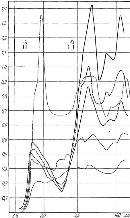
Abb. 129. Absorption von Boratgläsern nach DREISCH. (Schichtdicke 1 mm.)
