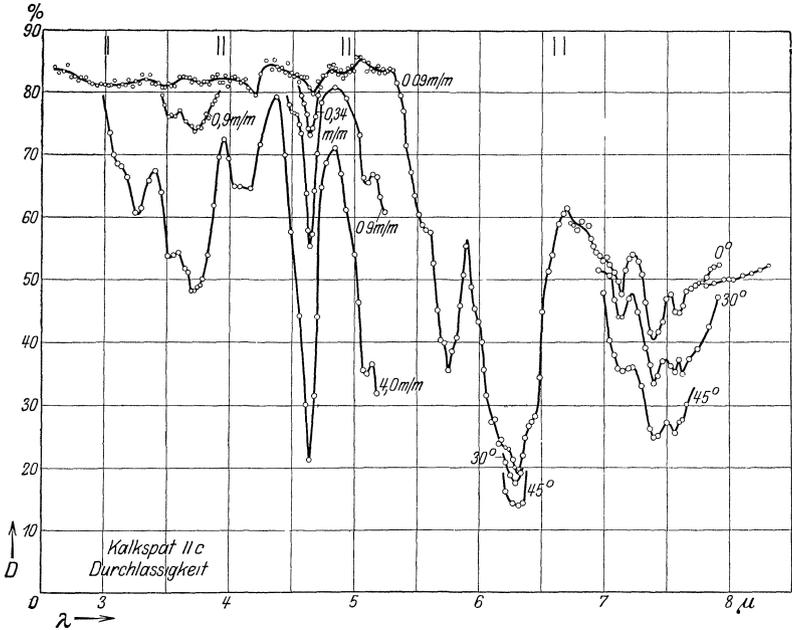
Abb 140 a Absorptionsspektrum des außerordentlichen Strahls für Kalkspat
