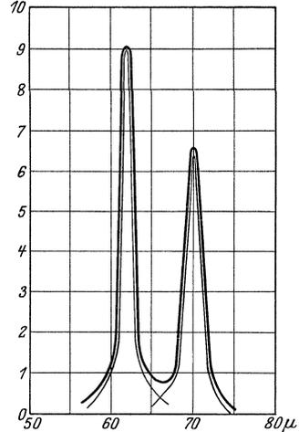
Abb. 33. Intensitätsverteilung der Interferometerkurve der Abb. 31.
