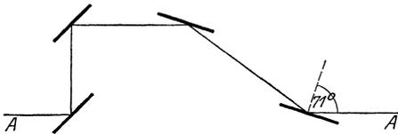
Abb. 41. Polarisatoranordnung nach PFUND.
