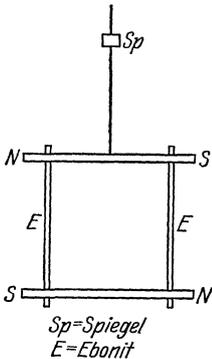
Abb. 13. Radiometer nach COBLENTZ.
