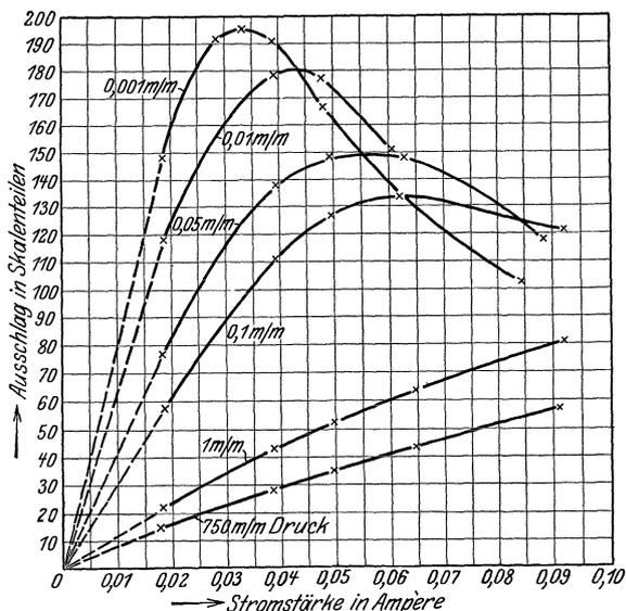
Abb. 18. Druckabhängigkeit der Bolometerempfindlichkeit.
