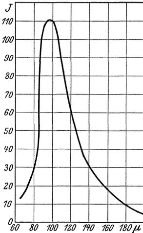
Abb. 38. Intensitätsverteilung der Strahlung des Auerstrumpfs für sehr lange Wellen.
