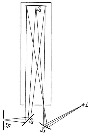
Abb. 71. Absorptionsrohr für Wasserdampf nach RUBENS und HETTNER.
