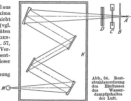
Abb. 34. Reststrahlenanordnung des Einflusses des Wasserdampfgehaltes der Luft.
