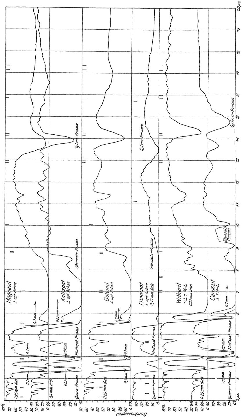
Abb 139. Durchlässigkeit der Karbonate im kurzwelligen Ultrarot nach SCHAEFER, BORNUTH, MAFOSSI.
