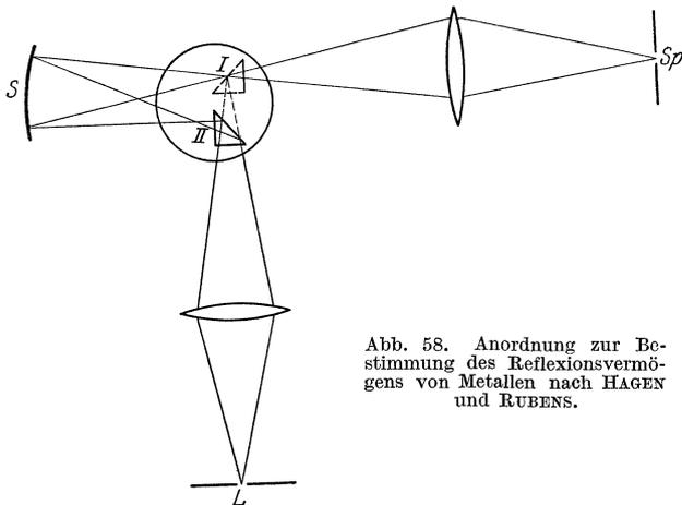
Abb. 58. Anordnung zur Bestimmung des Reflexionsvermögens von Metallen nach HAGEN und RUBENS.
