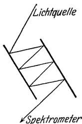
Abb. 59. Mehrfache Reflexion von Metallspiegeln.
