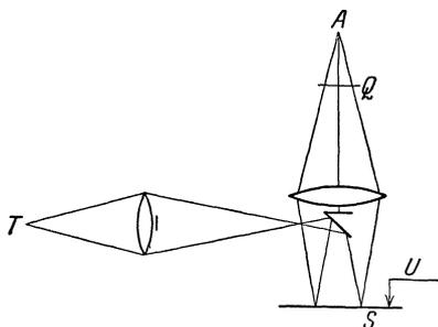
Abb. 54. Reflexionsanordnung für lange Wellen.
