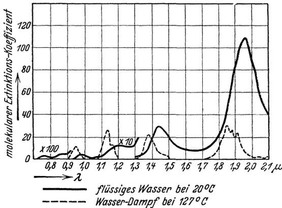
Abb. 104. Die Absorption von flüssigem Wasser und Wasserdampf.
