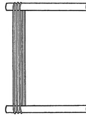
Abb. 21. Konstruktion der Drahtgitter nach DU BOIS und RUBENS.
