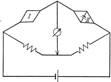
Abb. 17. Bolometerschaltung nach PAALZOW und RUBENS.
