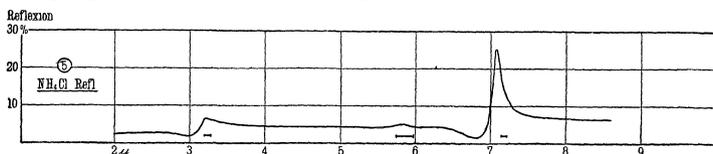
Abb. 138 a. Reflexionsvermögen von  $\text{NH}_4\text{Cl}$  nach REINKOBER.
