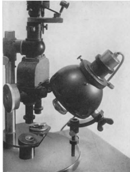
Abb. 5. Pulfrich-Photometer mit Spezialobjektiv für Staubbmessung im reflektierten Licht.
