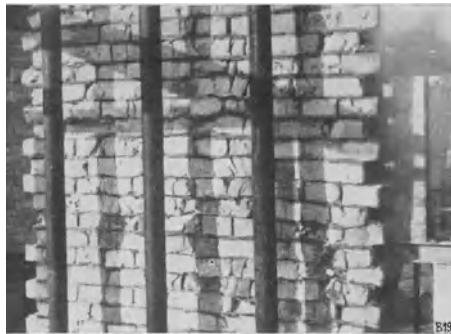
Bild 16. 3 m hoher Pfeiler aus Mauerziegeln mit 40 He.Pl. Belastung: 32 kg/cm 2 . Zusammendrückung: 27 cm.
