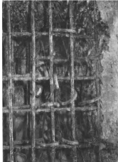
Abb. 12 und 13. Aufstimmung am Körper III (Kreidestriche: Abgerissenes Rundeisen).
