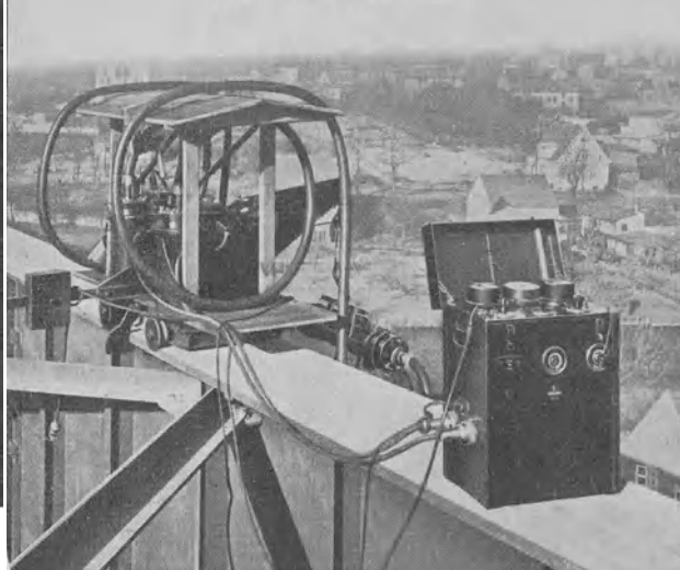
Untersuchung von Schweißnähten am Obergurt einer Brücke
