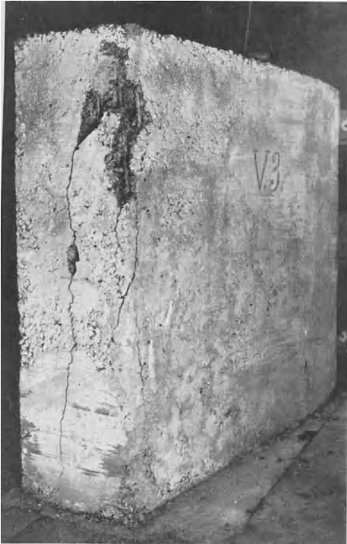
Abb. 10. Stirnfläche des Körpers III kurz nach dem Erreichen der Streckgrenze in den Rundeisen.
