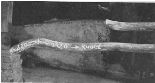
Abb. 11. Herausgezogene Eisenenden beim Versuchskörper III. Oberes Eisen: Haken abgebrochen. Unteres Eisen: Haken aufgebogen.
