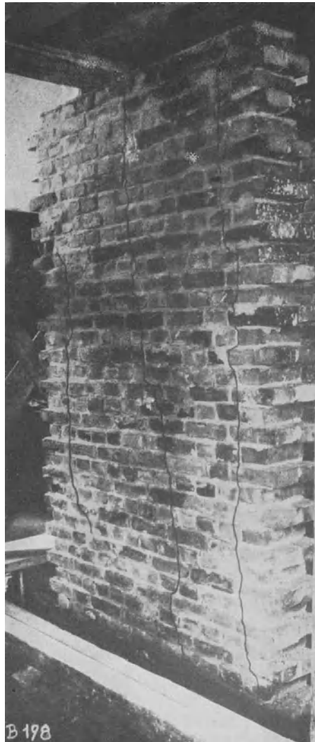
Bild 15. Mauerwerkkörper nach dem Versuch. Belastung: 48 \text{ kg/cm}^2 .
