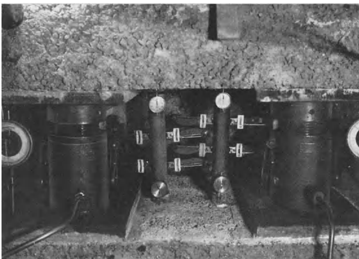
Abb. 7. Meßstellenanordnung am Versuchskörper II.
