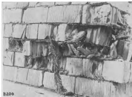
Bild 17. 1 m hoher Pfeiler aus Stawaziegeln mit 10 He.Pl. Belastung: 32 kg/cm 2 . Zusammendrückung: 5 . 3 cm.
