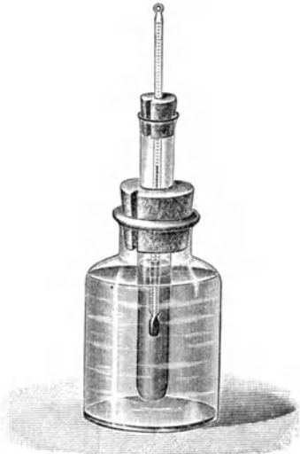
Fig. 124. Einfacher Apparat zur Bestimmung des Talgtiters.
