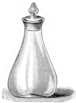
Fig. 57. (Nach B. FISCHER.) Jodabsorptionsgefäß von ca. 400 ccm Fassungsraum.
