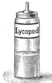
Fig. 29. HAMMER'sches Streugläschen für Lycopodium .
