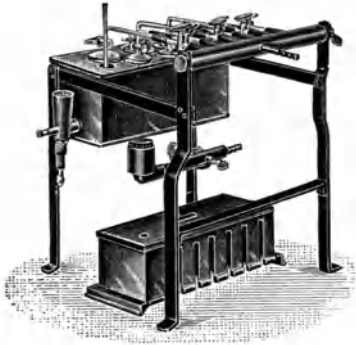
Abb. 184. Laboratoriums-Konditionierapparat nach E. Müller (H. Keyl-Dresden).
