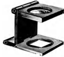
Abb. 275. Einfacher Fadenzähler (L. Schopper-Leipzig).
