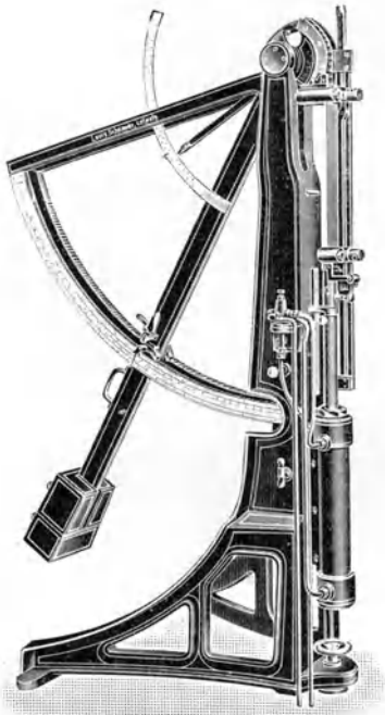
Abb. 232. Gewebefestigkeitsprüfer (L. Schopper).
