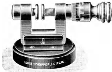
Abb. 201. Schraubenmikrometer (L. Schopper, Leipzig).
