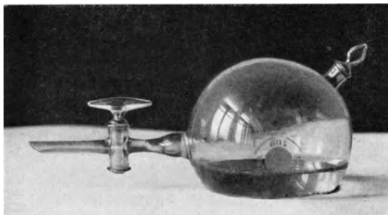
Abb. 3. Gefäß zur Bereitung und Filtration von Kupferoxydammoniak.
