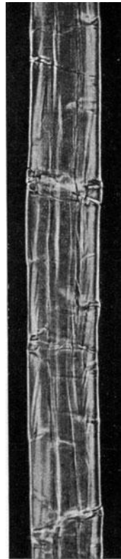
Abb. 110. Ramicfaser zwischen gekreuzten Nicols. Verschiebungen und Längszerklüftungen der Zellwand sehr deutlich. Vergr. 200.
