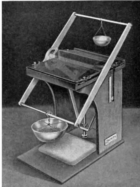
Abb. 296. Garn-Universalprüfer zur Feststellung der Dehnung.
