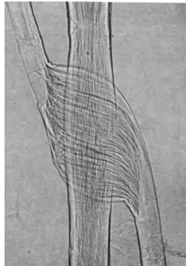
Abb. 76. Ramiefasern. Eine der beiden Fasern zeigt an der Quetschstelle zahlreiche Fibrillen. Vergr. 200.
