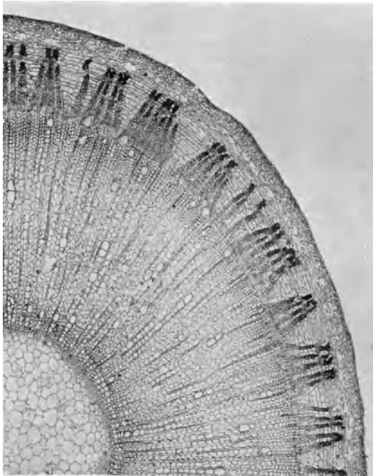
Abb. 69. Querschnitt durch einen grünreifen Jutestengel ( Corechorus olitorius ) mit zahlreichen primären und sekundären Bastbündeln. Die sekundären Bündel mit noch wenig verdickten Bastzellen. Vergr. 35.
