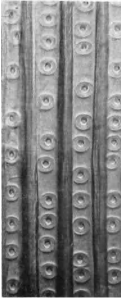
Abb. 117. Radialschnitt durch das Holz der Fichte. Die Tracheiden zeigen zahlreiche „Hoftüpfel“. Schiefe Beleuchtung. Vergr. 250.
