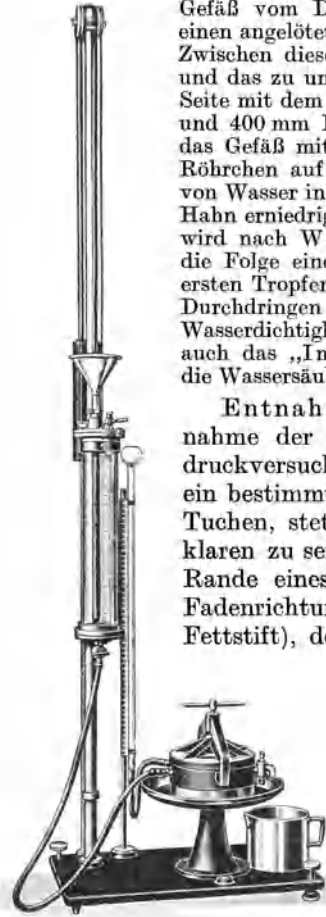
Abb. 305. Schoppers Wasserdurchlässigkeitsprüfer für Gewebe.
