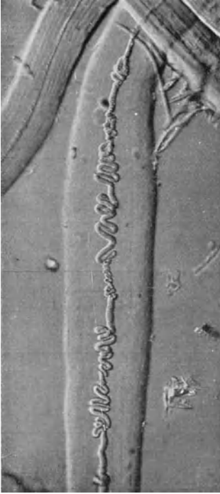
Abb. 97. Ungebleichte Flachsfaser in Kupferoxydammoniak. Die im Faserinnern befindlichen protoplasmatischen Reste schlangenartig gewunden. Vergr. 100.
