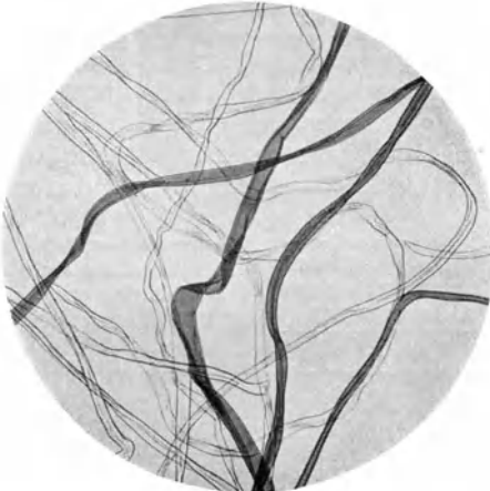
Abb. 13. Vergleichsmikroskopie. Im selben Präparat sind zwei verschiedene Baumwollsorten enthalten; eine derselben wurde vor der Präparation künstlich angefärbt (dunkel). Vergr. 80.
