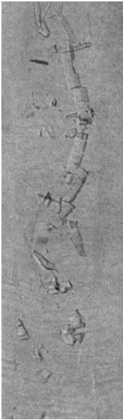
Abb. 104. Brennesselfaser in Kupferoxydammoniak. Die protoplasmatischen Reste des Faserrinnens sind spröde und splinterig. Vergr. 200.
