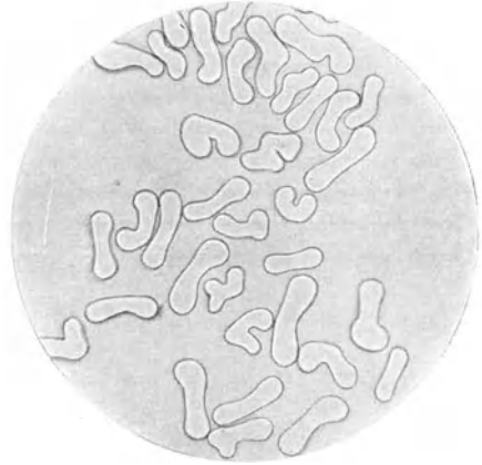
Abb. 45. Nitratseide. Mikrotomquerschnitte. Vergr. 173.
