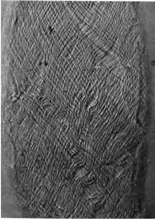
Abb. 106. Gebleichte Brennselfaser in Kupferoxydammoniak. Ausgezeichnete Spiralstruktur der Zellwand. Vergr. 200.
