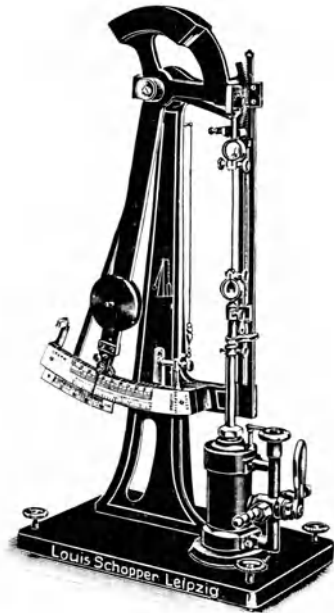
Abb. 231. Festigkeitsprüfer für Fasern, Faserbündel und Einzelhaare (L. Schopper).
