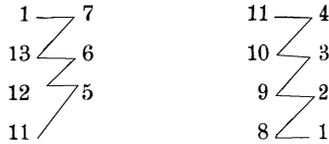
Wir zeichnen wieder in der bekannten Weise die Pfeile in die Drähte auf der Stirnfläche. Da in den Spulen 1 und 4 keine elektromotorische Kraft induziert wird, so lassen wir dort die Pfeile vorläufig weg. In allen anderen Spulen können wir über die Stromrichtung nicht zweifelhaft sein, und selbst Spule 7 betrachten wir noch als zum Südpol gehörig.
