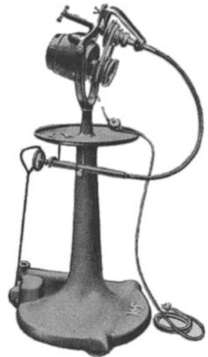
Abb. 68. Feil- und Schleifmaschine (Bauart Keller).
