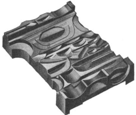
Abb. 61. Fräsmuster der „Van Norman“ Gesenkfräsmaschine.
