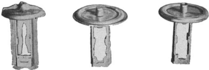
Abb. 48. Steuerkolben (AEG).
