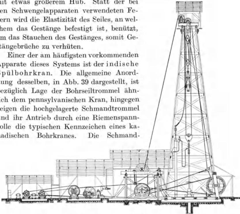
Abb. 39. Indischer Spülbohrkran für elektrischen Antrieb.
