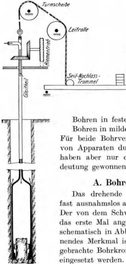
Abb. 40. Schematische Darstellung der Diamantbohrung.
