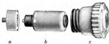
Abb. 141. Einzelteile einer Diazed-Sicherung.
