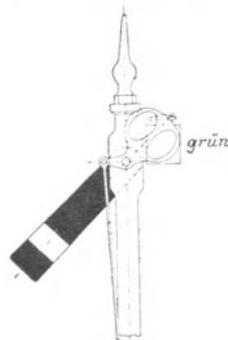
Mittels der Mastensignale werden nur 2 Signale gegeben: »halt« (danger) und »langsam fahren« (caution). Ersteres Signal wird durch den wagerecht liegenden Flügel (Fig. 49) bzw. durch rotes Licht, letzteres durch den unter 45° nach unten gerichteten Flügel (Fig. 50) bzw. durch grünes Licht angezeigt. Die Grundlaternen zeigen dieselben farbigen Lichter.
