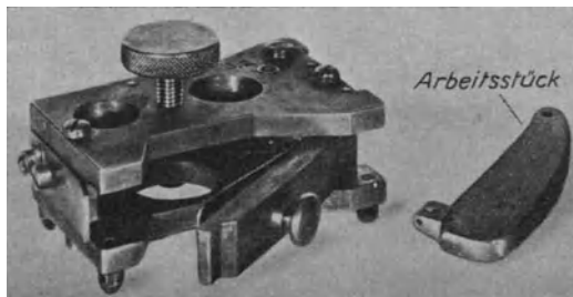
Abb. 624. Bohrvorrichtung für das Hebelstück zur elektrischen Handbohrmaschine.
