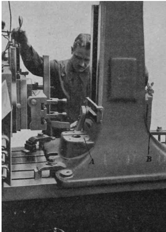
Abb. 640. Hobeln der Paßflächen am Ständer Abb. 638.
