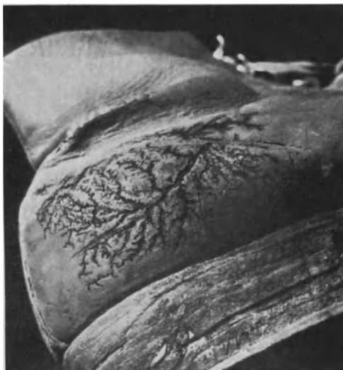
Abb. 6. Ausgeprägte Blitzfigur am Schuh eines elektrisch Verunglückten. (Sammlung ALVENSLEBEN.)
