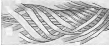
Abb. 6. Gequollene Bastfaser (schematisch) (nach Dippel)
