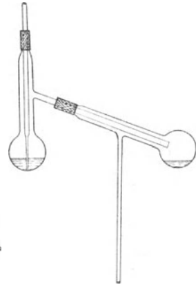
Fig. 36. Destillation nach Anschütz.
