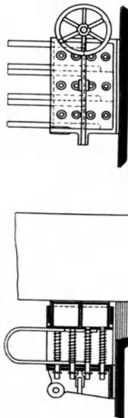
Fig. 196. Elastische Stromzuführung zu den Kohlenelektroden.
