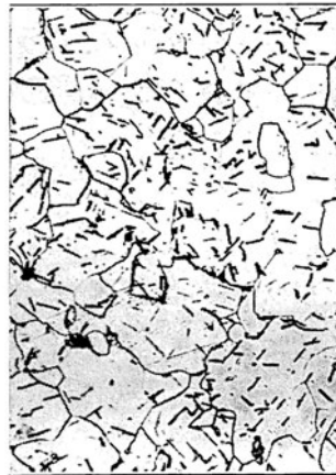
Abb. 131. Thomasstahl mit 0,021% Stickstoff 6 Stunden bei 250° angelassen. (Köster.) \times 200
