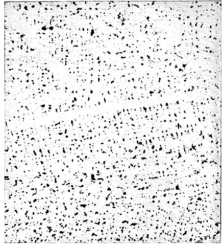
Abb. 247. Polierte Oberfläche von Messingguß mit 5,9% Pb. \times 50
