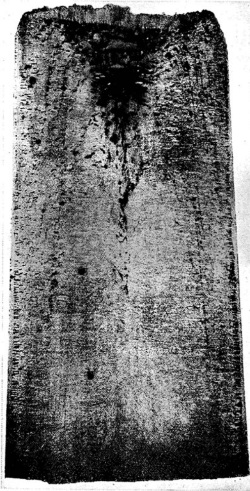
Abb. 172. 6,75 t-Block Weichstahl geteilt und geätzt. („Second Report on the Heterogeneity of Steel Ingots.“)
