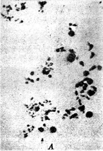
Abb. 120. Eisenoxydul-Aluminat-Einschlüsse mit Anzeichen der Zusammenballung in einer mit 0,48% Al versetzten Schmelze. (Herty.) × 400
