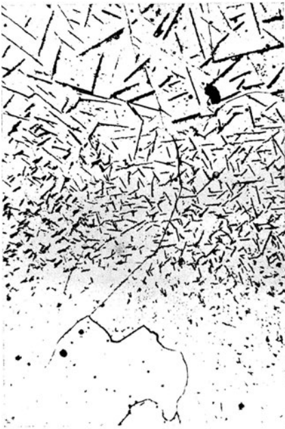
Abb. 106. Nitriertes Elektrolyteisen von 550° langsam erkaltet. (Köster.) × 200
