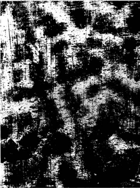
Abb. 133. Elektrolyteisen mit 0,059% O 2 . Ätzung salzsaure, verd. Kupferchloridlösung. (Treinen.) × 25
