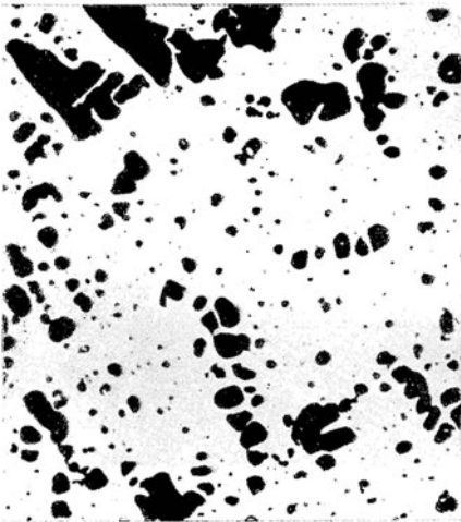
Abb. 8. Schwindungshohlräume im Sandguß einer Kanonenbronze. (Jenkin). \times 50
