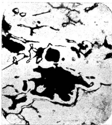
Abb. 237. Aluminium-Leichtlegierung mit Korrosionslöchern in der Nähe von \text{CuAl}_2 -Einschlüssen. \times 250 (Desch).
