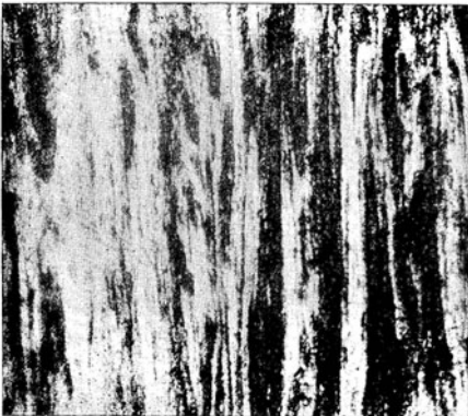
Abb. 13. Wie Abb. 11, auf 3 mm \varnothing gehämmert. × 100
