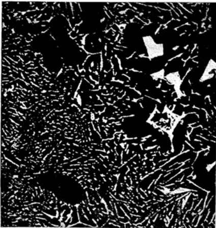
Abb. 73. Blei-Antimon-Legierung (87% Pb). Sandguß. Ätzung HCl. \times 200 .
