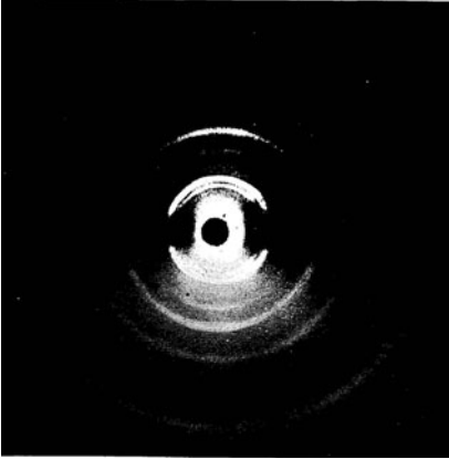
Abb. 19. Wolframstab nach dem Hämmern auf 2,0 mm \varnothing .
