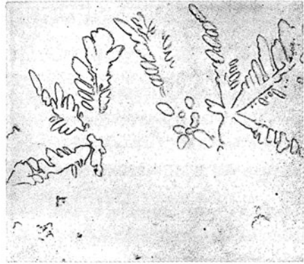
Abb. 65. Kupfer mit 3,51% Fe, Gußzustand. (Hanson und Ford.) \times 150
