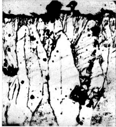
Abb. 28. Stengelkristalle in Elektrolytkupfer. Ätzung \text{NH}_4\text{OH} \times \text{H}_2\text{O}_2 . \times 500
