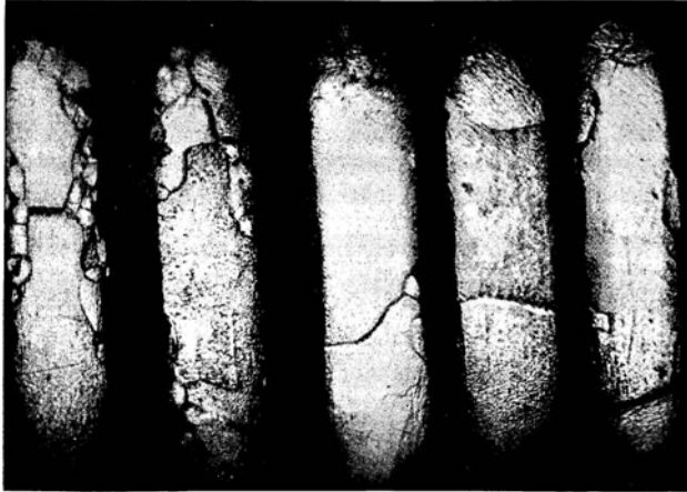
Abb. 147. Wolframdrahtspirale, hergestellt aus Oxyd mit weniger als 0,02% Verunreinigungen.
