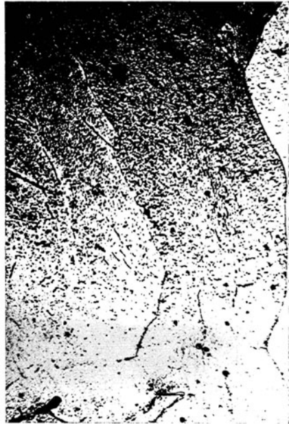
Abb. 108. Nitriertes Elektrolyteisen von 550° abgeschreckt und bei 250° angelassen. (Köster.) × 200
