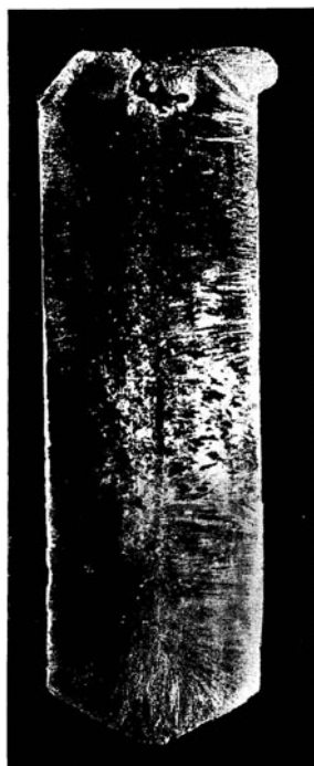
Abb. 7. Längsschnitt eines in eine Kokille gegossenen Zinkblockchens. Ätzung \text{HNO}_3 . \times 1
