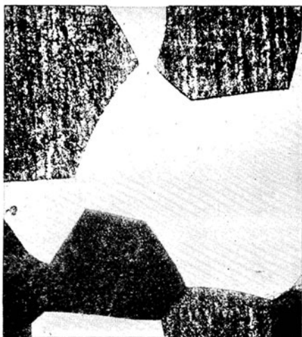
Abb. 144. Reiner W-Stab, 2 Min. bei 2700° C gegläht. Ätzung H_2O_2 . \times 100
