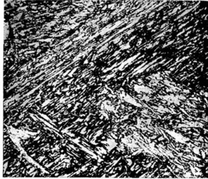
Abb. 112. Struktur in einer Eisenlegierung mit 12% Cr nach dem Schmelzen in Stickstoff. (Adcock.) \times 400
