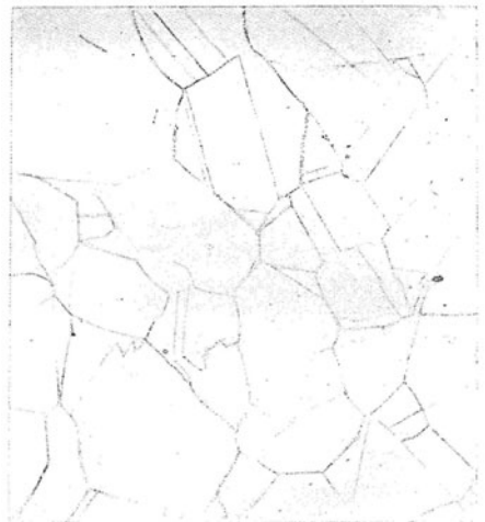
Abb. 33. Wie Abb. 32, kaltbearbeitet und gegläht bei 1000^{\circ}\text{C} . \times 100
