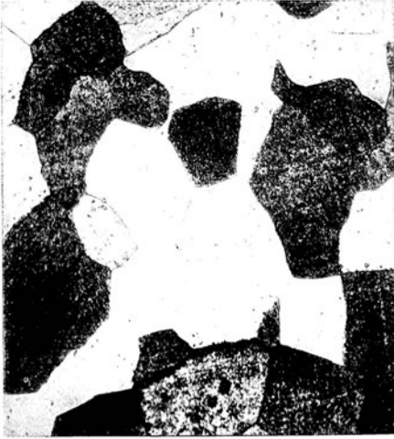
Abb. 23. Wolframstab auf 4,7 mm gehämmert und 2 Min. bei 2700 °C geglüht. \times 100
