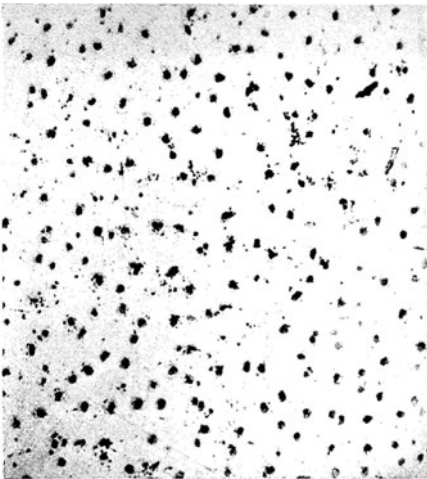
Abb. 63. Gewaltes Zink mit 3,3% Pb, 2,6% Sn und 2,1% Fe. Ungeätzt. × 50.
