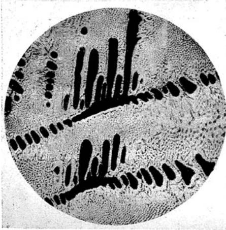
Abb. 40. Kupferreiche Dendriten vom Cu-Ag-Eutektikum umgeben. (Desch.) \times 200
