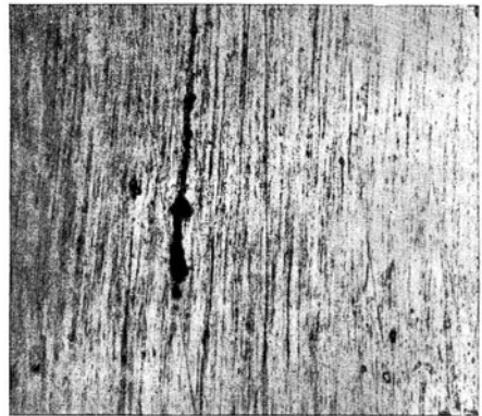
Abb. 16. Kupferstab nach 99% Kaltverformung. Ätzung NH_3 + H_2O_2 . × 500
