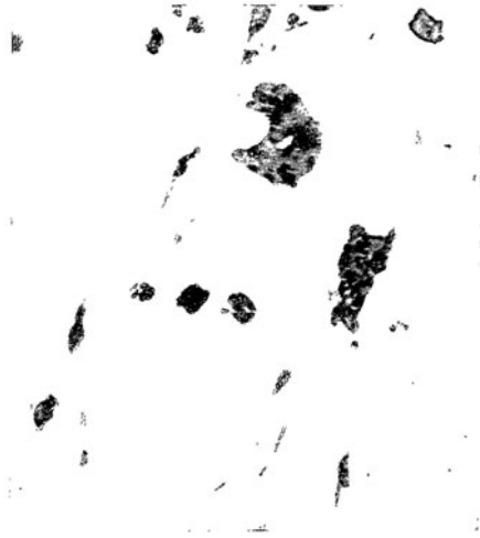
Abb. 239. Schlackeneinschlüsse in Indischem Eisen des 12. Jahrhunderts. \times 50
