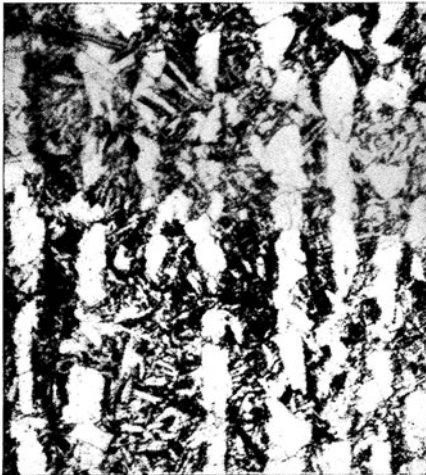
Abb. 138. 5% Ni-Stahl mit Ferritzeile, Ätzung \text{HNO}_3 . \times 200
