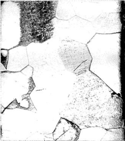
Abb. 25. 1,0 mm Wolframdraht kaltbearbeitet und 2 Min. bei 2700 °C geglüht. \times 100
