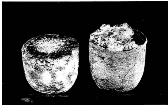
Abb. 168. Links Silber mit 1% Cu. Rechts reines Silber. Beide Blöckchen wurden an Luft geschmolzen und gegossen. \times \frac{1}{2} .
