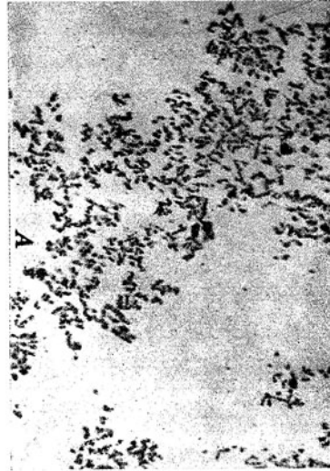
Abb. 121. Tonerde-Einschlüsse in einer mit 0,186% Al vollkommen desoxydierten Schmelze. (Herty.) × 400
