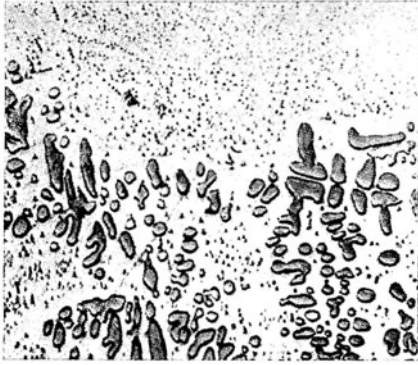
Abb. 123. Kupfer mit 1,33% Sauerstoff. Gußzustand, ungeätzt. (Nach Hanson, Marryat u. Ford.) \times 150
