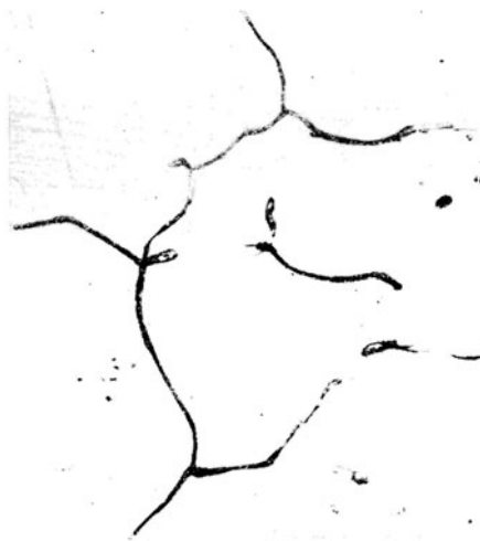
Abb. 91. Kupferband bei 800° C in Wasserstoff geglüht, mit interkristallinen Brüchen. \times 500 .
