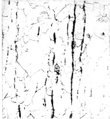
Abb. 116. Geglühtes Schweiß Eisen mit Schlackenteilen. Ätzung alkal. \text{HNO}_3 . \times 100
