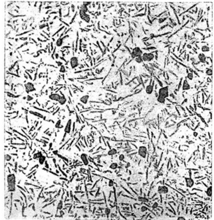
Abb. 70. Wie Abb. 69, bei 750° C mit 0,01% Na behandelt. × 200
