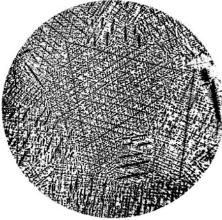
Abb. 30. Gegossenes \alpha -Messing (90/10). \times 50
