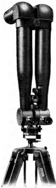
Abb. 316. Das Scherenfernrohr zum Gebrauch des Landheeres.
