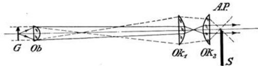
Abb. 77. Die beim EXNERSchen Verfahren benutzte Schneide  $S$  wird am Orte der Austrittspupille  $A.P.$  des Mikroskops bis zur optischen Achse vorgeschoben. Dadurch erscheint das in einer nahezu gleichbrechenden Flüssigkeit eingebettete Ding  $G$  reliefartig mit scharfen Schatten und Lichtern, die sich ändern mit der sich ändernden Brechzahl der Flüssigkeit, und die beim Durchgange durch die Gleichheit der Brechzahlen von Flüssigkeit und Präparat von einer Seite auf die andere umschlagen.
