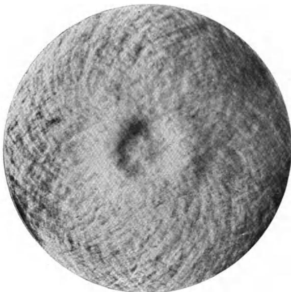
Abb. 130. Das mit einer FOUCAULTSchen Schneide gesehene (photographierte), reliefartige Bild der Zonen sphärischer Abweichungen am 80 cm-Objektiv des Potsdamer Refraktors.
