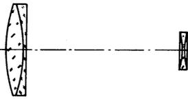
Abb. 255. Ein holländisches Fernrohr der üblichen Art.
