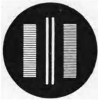
Abb. 143. Der zur Feststellung der Fehler seitlich der Achse beim WETTHAUERSchen Verfahren der streifenden Abbildung zu benutzende Testspalt besitzt in der Mitte einen feinen Doppelspalt, auf dessen beiden Seiten zwei Systeme von sehr feinen Querspalten angeordnet sind. Der Doppelspalt dient der Ermittlung der tangentialen Bildkrümmung, die Querspalte der Ermittlung der sagittalen Bildkrümmung.
