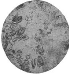
Fig. 5. Bimssteinpulver.
