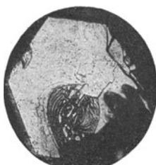
Fig. 33. Karborundumkristall, Basisfläche mit muschligem Ausbruch.
