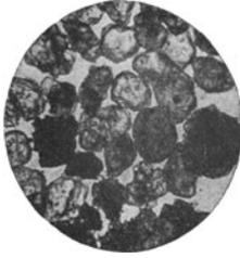
Fig. 9. Angeschwemmter Quarz mit abgerundeten Kanten.
