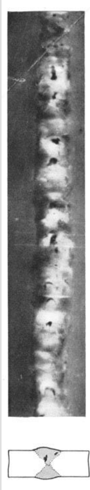
a) Grobe Schlacken in einem stehend geschweißten Stegblech aus Stahl 37. Die von der Ummantelung der Elektrode herrührende Schlacke wurde beim Schweißen der einzelnen Lagen nicht sorgfältig entfernt.
