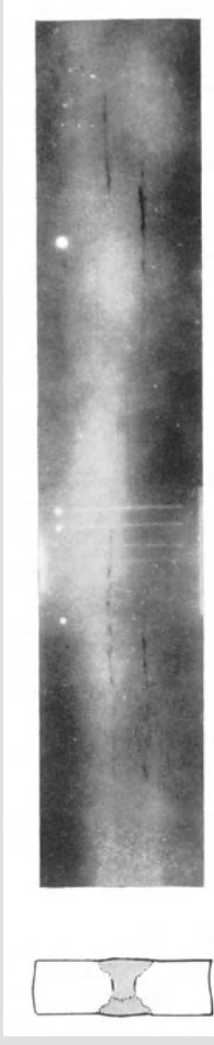
b) Feine Schlacken in einem abgewulsteten Stegblechstoß aus Stahl 52. Durch Verwendung eines U-förmigen Meißels beim Vorbereiten der Gegen-schweißung entstanden senkrechte Rindflächen, an denen sich Schlacken abgelagert
