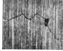
d) Mikroaufnahme M. 1 · 100 der getätzten Oberfläche zeigt Risse und Ausbrüche
