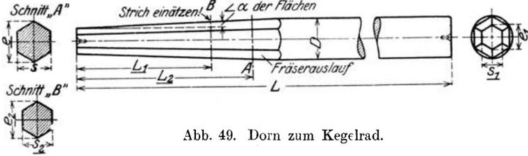
Abb. 49. Dorn zum Kegelrad.
