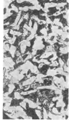
Abb. 49. Kerngefüge: Ferrit mit lamellarem Perlit.
