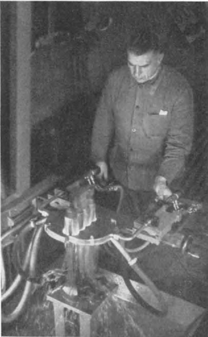
Abb. 26. Brennhärten von Brikettprädestempeln auf einer Senkrecht-Härtemaschine.
