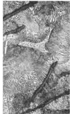
Abb. 61. Kern: Lamellarer Perlit mit eingelagerten Graphitadern.
