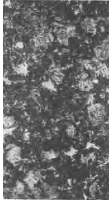
Abb. 48. Übergangszone: Martensit, Troostit und Ferrit.
