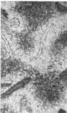
Abb. 59. Rand: Martensit. Die eingelagerten Graphitadern sind erhalten geblieben.
