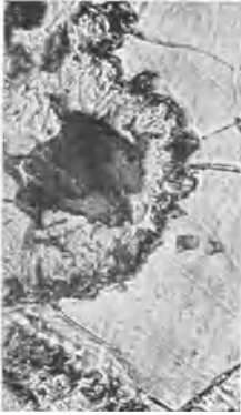
Abb. 57. Die 500fache Vergrößerung zeigt, daß um die Temperkohlenester herum eine starke Aufkohlung stattgefunden hat, so daß sich bei der Abkühlung ein Martensitkranz um die Temperkohle gebildet hat. Das noch kaum beeinflusste ferritische Grundgefüge ist deutlich erkennbar. Härtetemperatur 800° C.
