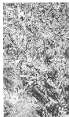
Abb. 56. Übersichtsaufnahme eines brenngehärteten Chrom-Molybdän-Stahles VCMo 135 ( V = 200 \times ) (Ausschnitt).
