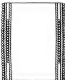
Abb. 59. Hochfrequenztransformator mit Zylinderspulen.
