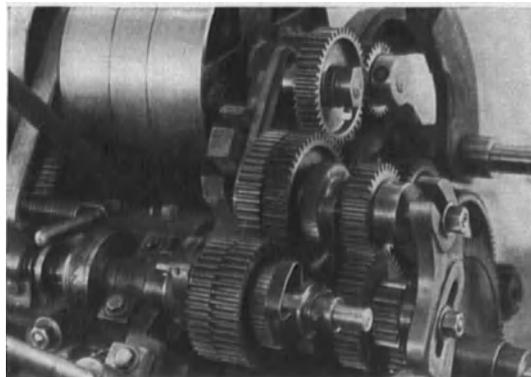
Abb. 230. Räderbetrieb für Wagenauszug und Zylinderlieferung.
