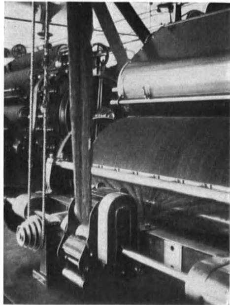
Abb. 163. Einzugsvorrichtung für den Krempelflor.
