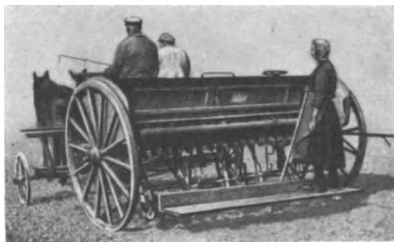
Abb. 12. Sämaschine zum Mitfahren der Bedienungsmannschaft eingerichtet von der Versuchsanstalt in Pommritz
