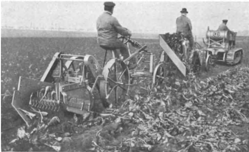
Abb. 31. Siederslebner Rübenkopf- und Rübenerodemaschine mit W.-D.-Schlepper der „Hanomag“
