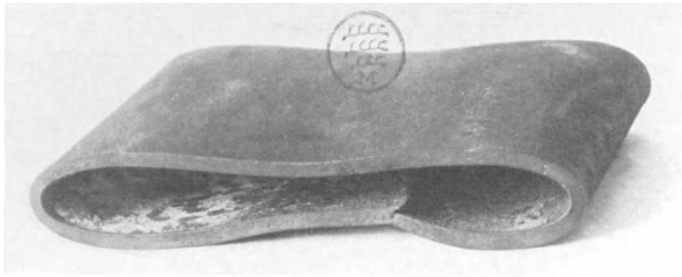
Abb. 61. Bruch der Abschreckbiegeprobe des Rohres Abb. 56.
