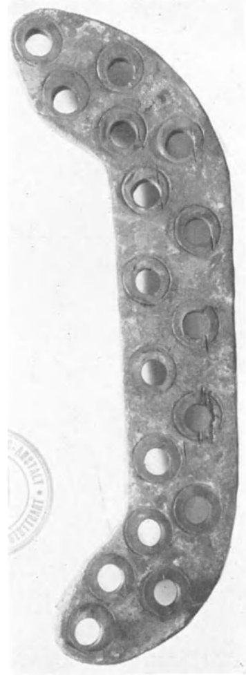
Abb. 9. Stemmformen um die Nietköpfe der Verstärkungsflasche.
