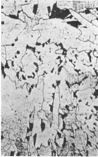
Abb. 1 zeigt das Gefüge eines rohge- gossenen Blockes — sehr grobe Kristalle. V = 100
