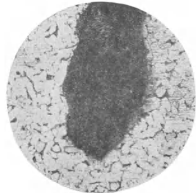
Abb. 1 b. Korrosionsriß, 50fach vergrößert.
