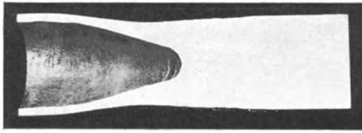
Abb. 9. Längsschnitt durch ein Lochstück eines Stiefelwalzwerks.
