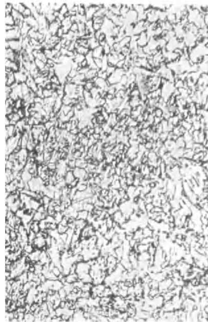
Abb. 17. Gefüge des gebrauchten Siederohres an der Einwalzstelle. V = 100 .
