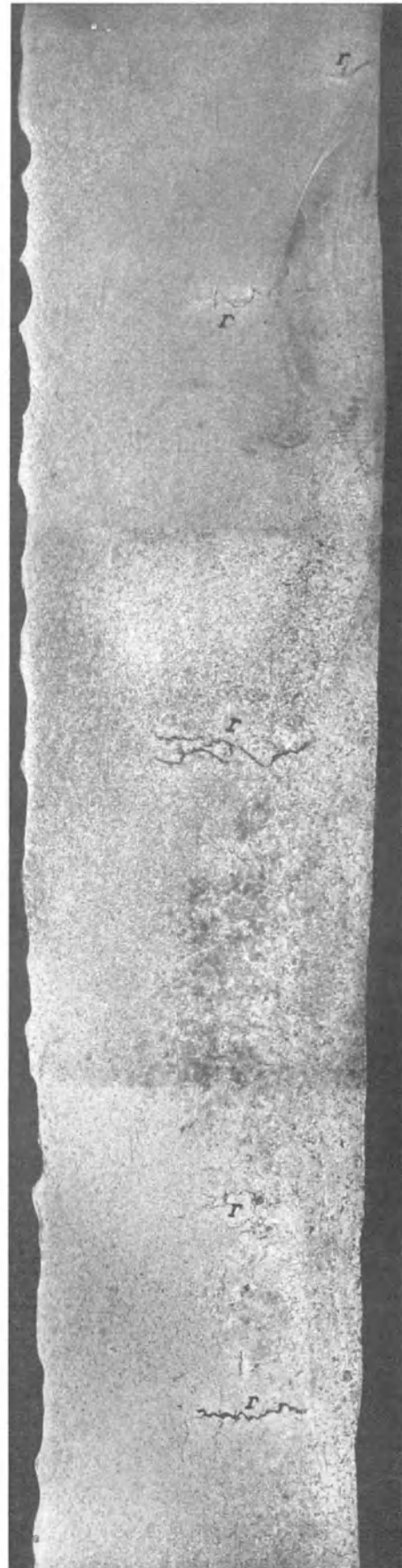
Abb. 34. Zugeschmolzene Risse, deren Enden noch im Blech erkennbar sind. V = 5 .
