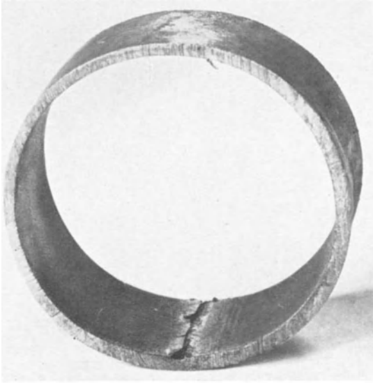
Abb. 6. Schalenbildung an der Rohrinneiseite.
