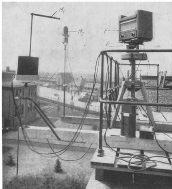
Abb. 420. Anordnung zur Messung der Schallstrahlung eines Empfängers E im Freien.  $M_1$  und  $M_2$  Mikrophone, D Drehschemel mit Motorantrieb.
