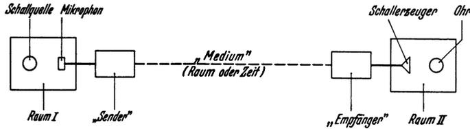
Abb. 97. Die verschiedenen Glieder einer Schallübertragung und ihre Störungsursachen. „Sender“ kann z. B. ein Schallplattengerät oder Tonfilmgerät sein. Die Andeutungen „Medium“ sowie „Empfänger“ sind ebenfalls im weitesten Sinne aufzufassen. Störungsursachen: Raum I und II: Mangelnde Schallsolation, also z. B. Straßenlärm. Mikrophon: Eigenrauschen, störepfindliche Leitungen. Sender, Empfänger: Rauschen von Verstärkern (Widerständen und Röhren). Medium: Atmosphärische Störungen, Nadelgeräusche.
