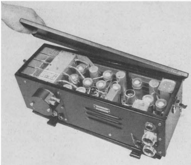
Abb. 408b. Innerer Bau eines Flugzeugempfängers.
