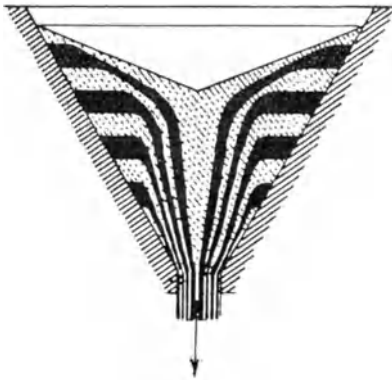
Abb. 201. Abfluß aus der Bodenöffnung von Silozellen.
