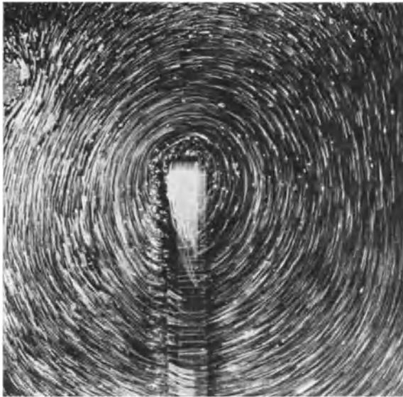
Abb. 64. Umströmung einer scharfen Zacke.
