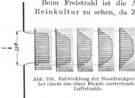
Abb. 104. Entwicklung der Staudruckprofile bei einem aus einer Blende austretenden Luftstrahl.
