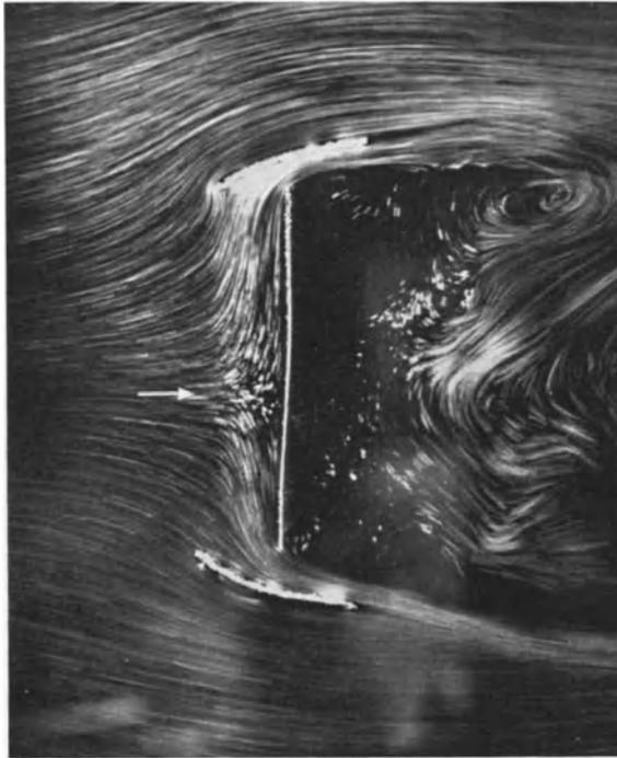
Abb. 220. Hilfsflügel verhindern das weite Ausweichen der Strömung und verringern den Widerstand um etwa 50 v. H.
