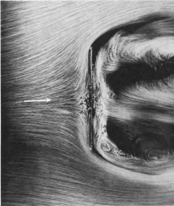
Abb. 219. Strömung um eine senkrecht angestellte Platte.
