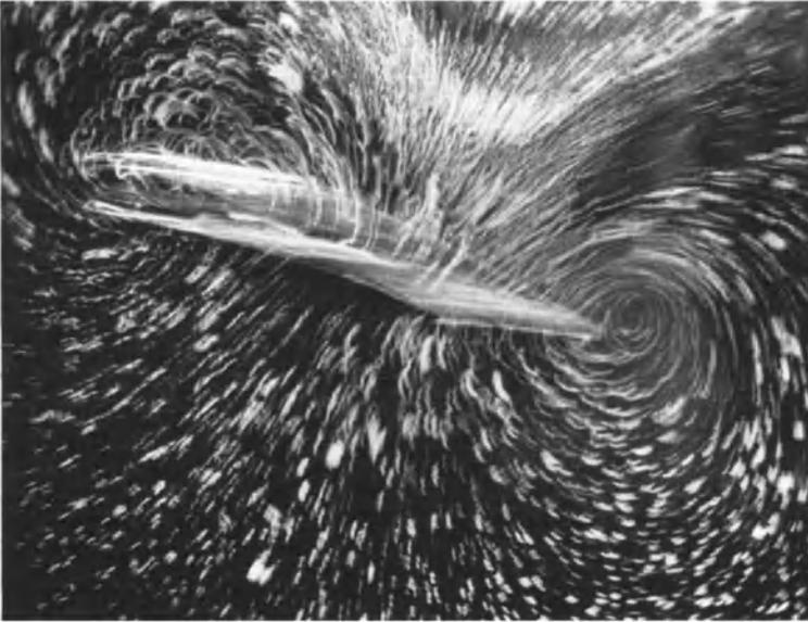
Abb. 179. Strömungsbild kurz nach dem Start. Der Zirkulationswirbel und der Anfahrwirbel sind deutlich zu erkennen.
