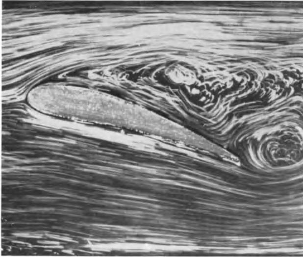
Abb. 207. Abgerissene Tragflächenströmung.
