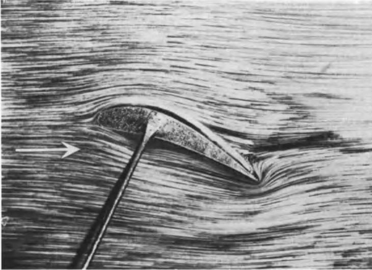
Abb. 183. Reibungsfreie Umströmung eines Tragflügels.
