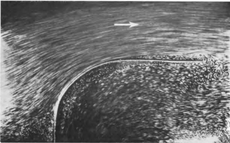
Abb. 142. Unterkritische Strömung durch *I-G*-Düse  $R_D \sim 55\,000$ . Strömung löst sich ab und füllt Endquerschnitt nicht aus.
