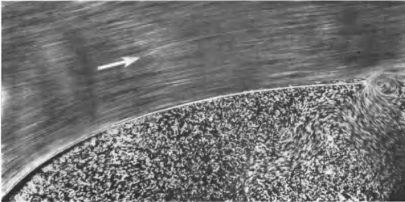
Abb. 140. Strömung durch VDI-Düse 1912. Keine Ablösung, laminare Grenzschicht, deren Dicke sich mit  $Re_D$  ändert.  $Re_D \sim 140\,000$ .
