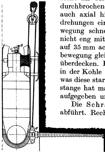
Abb. 455. Schrämmaschine mit einseitig aufgesetzter, umsteckbarer Windentrommel (Flottmann.)
