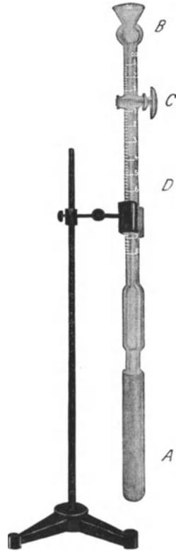
Abb. 83. Apparat zur Harnstoffbestimmung im Blut.
