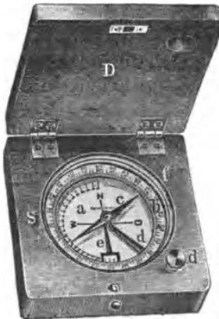
Das flache Holzgehäuse ist quadratisch oder rechteckig und mit dem Holzdeckel so verbunden, daß beim vollen Aufklappen desselben seine Kanten in die genaue Verlängerung der entsprechenden Gehäusekanten fallen.
