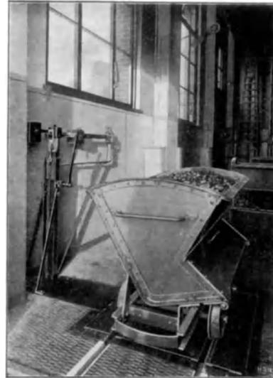
Fig. 195. Zentesimalwaage im Kesselhaushaus.
