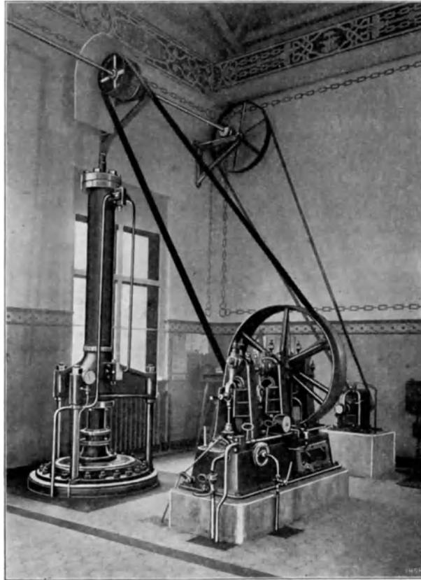
Fig. 204. Pumpwerk und Dampfakkumulator für 200 atm. Maschinenbaugesellschaft Nürnberg.
