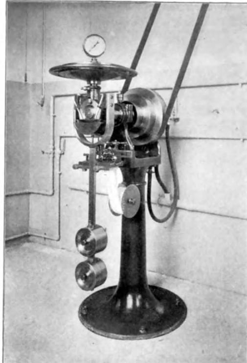
Fig. 239. Schmierölprobiermaschine von Martens.
