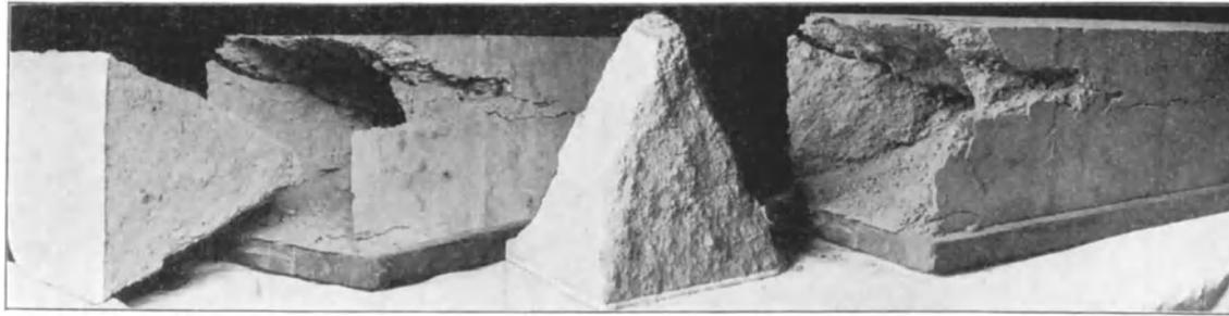
Druckversuch mit Betonsaule.
