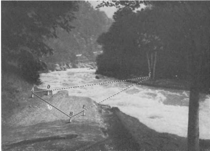
Abb. 34. Wie man über einen Fluß hinweg die Entfernung bestimmt. Auf die in der Abbildung veranschaulichte Art kann man die Entfernung eines Punktes finden, der am anderen Ufer eines Flusses liegt. Man braucht dazu kein weiteres Meßinstrument als eine Meßschnur.
