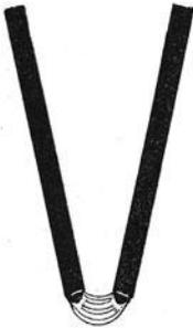
Fig. 216. Lichtbogen bei schräg nebeneinander angeordneten Kohlen.
