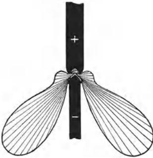
Fig. 211. Lichtverteilung eines Gleichstromlichtbogens.
