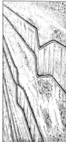
Fig. 124. Pressungserscheinungen in Geleisen.
