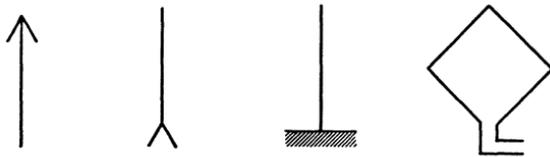
Abb. 87. Antenne, Gegengewicht, Erde und Rahmenantenne.
