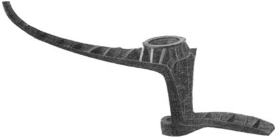
Abb. 273. Hinterstevan aus S. M. Stahlguß. Gewicht 12400 kg.
