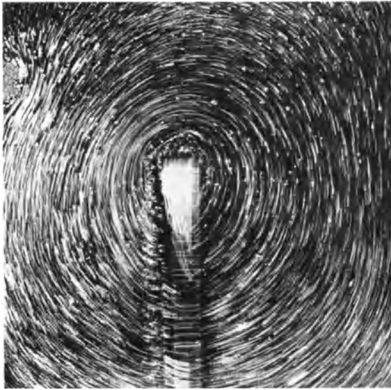
Abb. 46. Umströmung einer scharfen Zacke. Absolutstromlinien der reibungsfreien Strömung.
