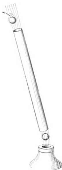
Abb. 54. Niedrig schwebender Ball schießt bei Annäherung einer Papprolle durch dieselbe.
