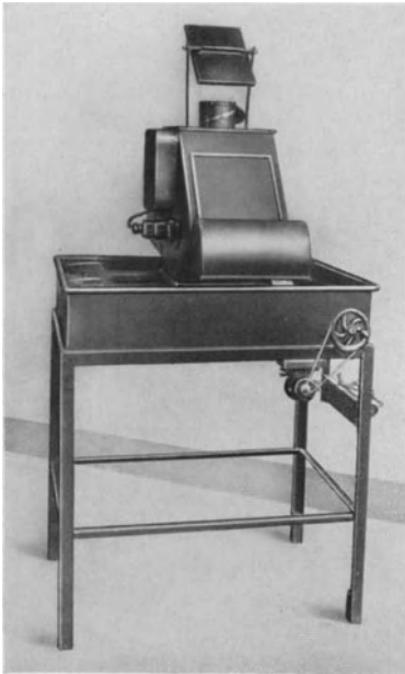
Abb. 23. Wasserwanne mit Episkop zur Projektion von Strömungsbildern.
