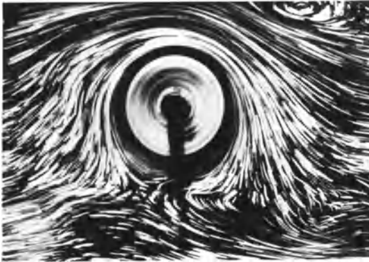
Abb. 35. Magnuseffekt. Zylinder, an einem gedrehten Faden aufgehängt, läuft ab.
