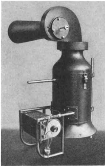
Abb. 77. Spiralgehäuse mit Kaplan-Turbine und konischem Saugrohr, durch Windkanal angetrieben.
