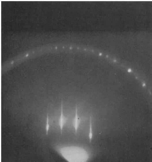
Abb. 19. Reflexionsaufnahme an (100) von Pyrit; 100-Azimut. — 0. und 1. Ordnung von III.
