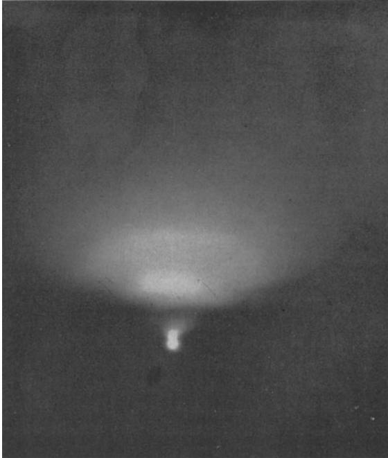
Abb. 40. Reflexionsaufnahme einer Goldschicht, die gleichzeitig mit der in Abb. 39 auf eine Glasplatte aufgedampft wurde. Stark verbreiterte Interferenzen.
