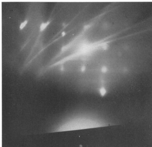
Abb. 11. Reflexionsaufnahme mit  $40kV$ -Elektronen an (100) von  $NaCl$ ; (100)-Azimut.<sup>1</sup>
