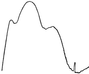
Abb. 45. Photometerkurve einer Streuaufnahme von  $CCl_4$  (BEWILOGUA 6).
