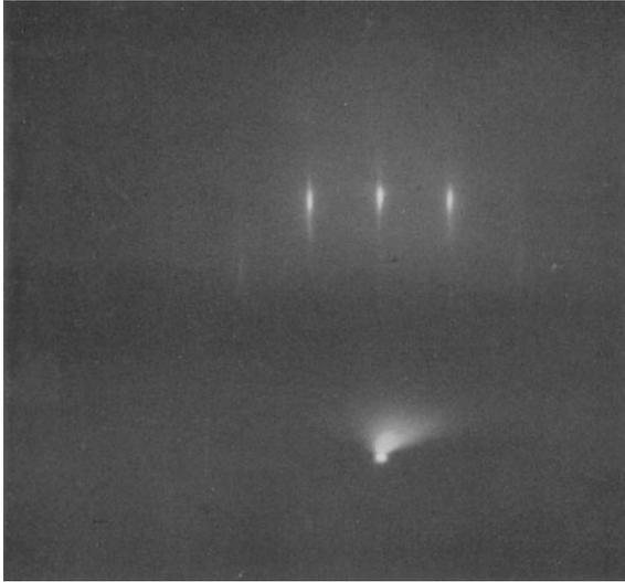
Abb. 18. Reflexionsaufnahme mit 40 kV-Elektronen an (100) von  $FeS_2$ , Pyrit; 100-Azimut. Interferenzkegel nullter Ordnung der Punktreihe III (s. Abb. 16 b).
