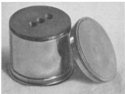
Abb. 13. Metalldose mit ausgegossenem Blei zum Transport der Radiumträger
