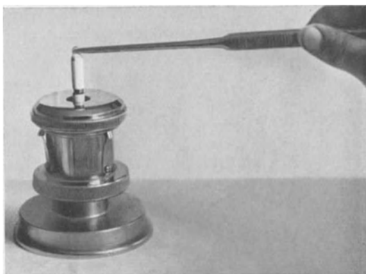
Abb. 12. Apparat zur Einbringung von Radiumtuben in Filter
