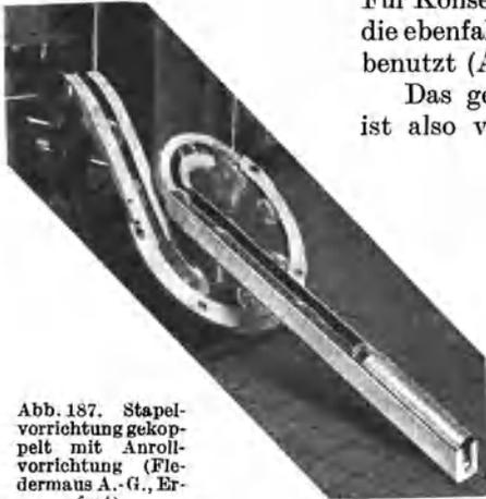
Abb. 187. Stapelvorrichtung gekoppelt mit Anrollvorrichtung (Fleidermaus A.-G., Erfurt).
