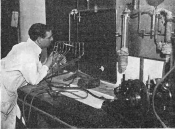
Abb. 608. Anschmelzen eines Rohres an die Hochvakuumpumpe.
