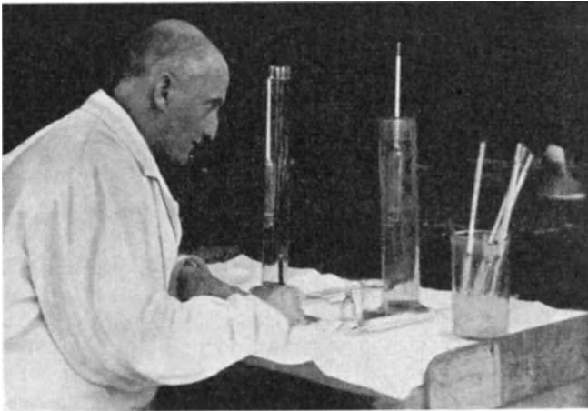
Abb. 600. Bestimmung der Punkte am Aräometer.
