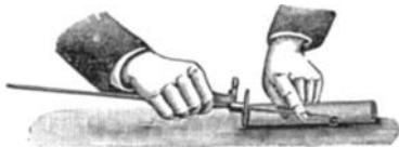
Abb. 41. Schneiden mit dem Diamant.
