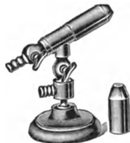
Abb. 16. Brenner für Apparatebau.
