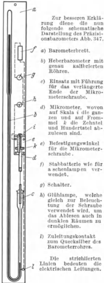
Abb. 347. Schematische Darstellung des Präzisionsbarometers.
