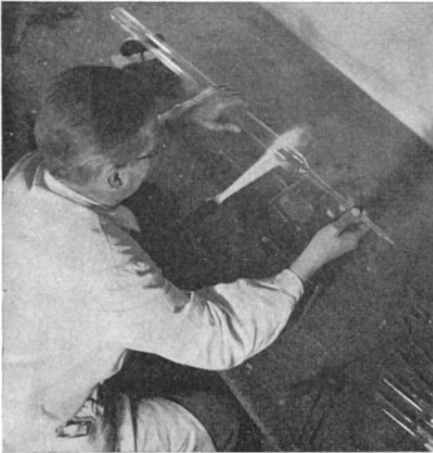
Abb. 85. Erwärmen zum Abziehen eines Werkstückes.
