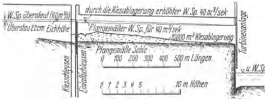
Abb. 163. Kiesablagerung in einem Werkkanal, Längenschnitt. (Hartmann: Bautechn. 1926.)
