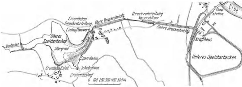
Abb. 139. Pumpspeicherwerk Niederwartha, Lageplan. (Wasserkr. u. Wasserwirtsch. 1930.)
