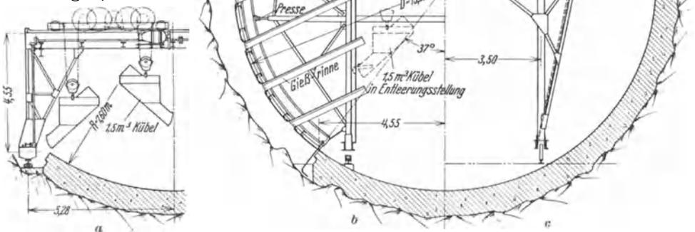
Abb. 287. Auskleidung der Umlaufstollen der Hooversperre. (Engng. News Rec. 1932.) a Sohlenbetonierung. b Einbringung des Seitenbetons. c Verfahrbares Gewölbeschalung. (Im Gewölbe Preßluftbetonierung!)
