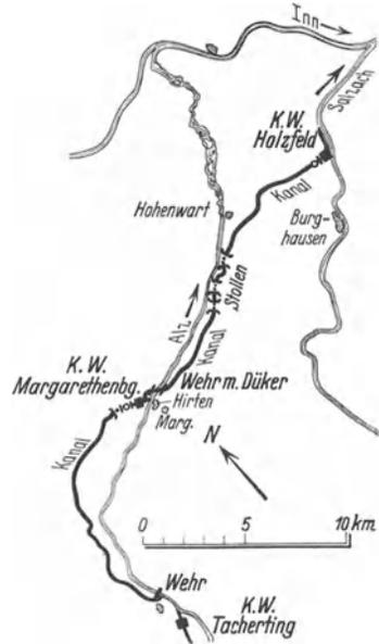
Abb. 101. Übersichtsplan des Ausbaues der Alz abwärts Tacherting. (Bayer. Staatsmin. d. I. 1926.)
