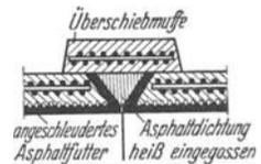
Abb. 333. Stoßverbindung eines Billé-Ligonnet-Eisenbetonrohres mit Überschiebmuffe. (Bautechn. 1930.)
