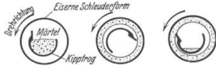
Abb. 331. Schleudervorgang beim Verfahren Moir und Buchanan, Wirkungsweise des Kipptrages und Abstreifmessers. (Bautechn. 1930.)
