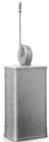
Fig. 54. Steuerwalze mit senkrechter Nullstellung des Hebels, für Fahrwerke.
