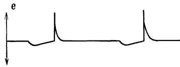
Abb. 1. Verschiedene Stromformen. a kontinuierlicher Gleichstrom. b pulsierender Gleichstrom. c unterbrochener Gleichstrom. d sinusförmiger Wechselstrom. e faradischer Strom.
