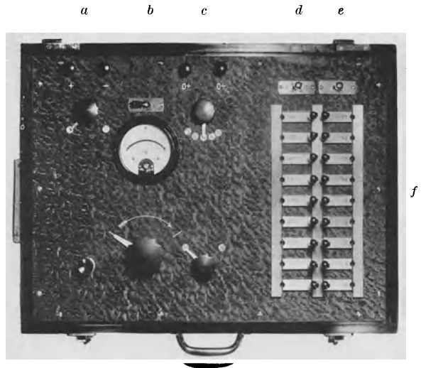
Abb. 8. Transportable Apparat zur Chronaxiebestimmung mit Kondensatorentladungen. (Nach ALTENBURGER.) Originalgröße 40 × 56 cm. Der abnehmbare Verschlussdeckel ist entfernt. + - und - - Klemmen für die Stromzuführung. O + - und O - - Klemmen für den Anschluß des Untersuchungsobjektes. a Ein- und Ausschaltung der Stromzufuhr. b Kipphebel zur automatischen Rheobasenverdoppelung. c Umschalter für die verschiedenen Meßbereiche des Voltmeters. d Kipphebel, der die Reizung mit Kondensatorentladungen und direkte Entnahme von Gleichstrom zur galvanischen Untersuchung ermöglicht. e Kipphebel für wahlweise Einschaltung von 6000 bzw. 11 000 Ohm Widerstand. (Vgl. Schaltschema Abb. 7, dem auch der innere Aufbau des Apparates entspricht.) g Taste für Ladung und Entladung des Kondensators. h Potentiometer. i Stromwender.
