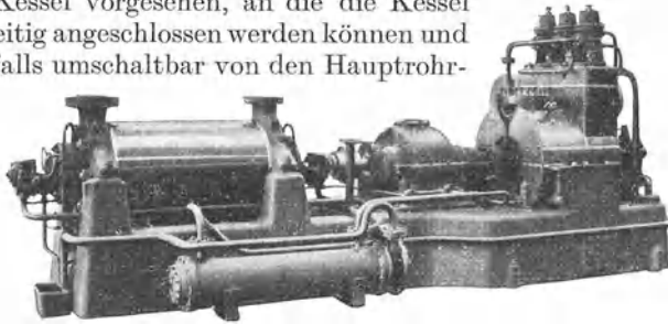
Abb. 212. Speisewasserpumpe mit Dampfturbinenantrieb und Getriebe.
