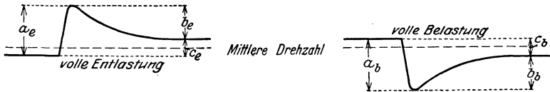
Abb. 347. Drehzahländerung für einen Entlastungs- und einen Belastungsvorgang mit Ungleichförmigkeit im Regler.
