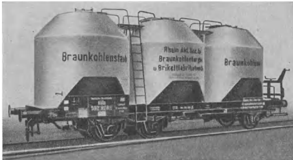
Abb. 99. Behälterwagen für blasfertigen Kohlenstaub.
