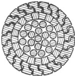
Abb. 26. Verschlossenes Seil mit Keildrähten.
