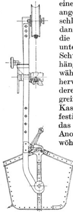
Abb. 95. Seilbahnwagen mit selbsttätig aufkippendem Kasten.
