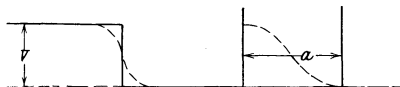
Fig. 40. Verlauf der Spannungswoge bei plötzlichem Einschalten des Schalters in Fig. 39. Nach FIELD.
