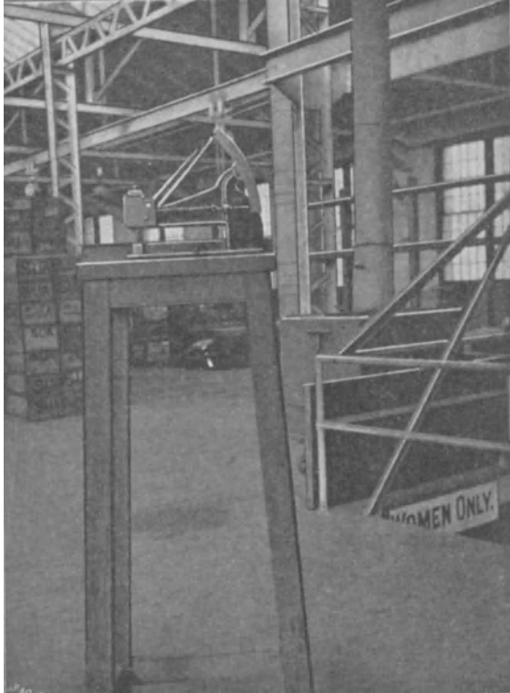
Fig. 149. Dickenmesser für Mikanitplatten.
