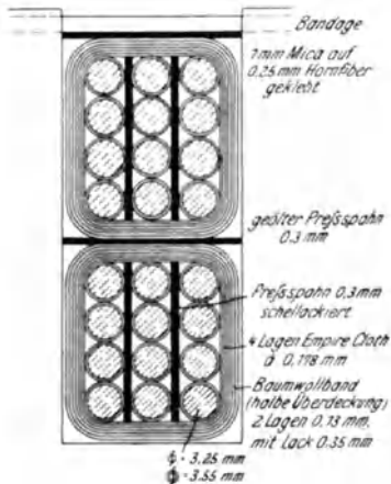
Fig. 93. Nut ohne Nutauskleidung.
