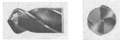
Abb. 60. Sonderanschliff für das Bohren von Gußeisen.
