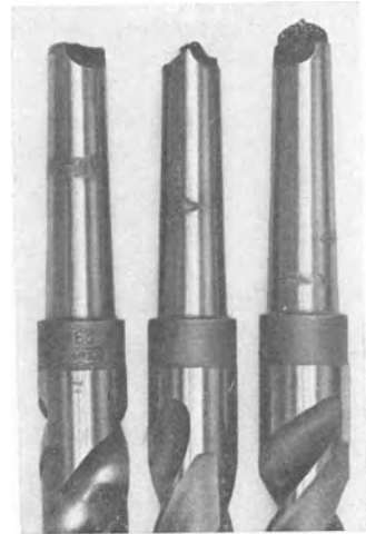
Abb. 52. Bohrer mit beschädigtem Schaft.
