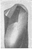
Abb. 35. Spiralbohrer mit Hartmetallschneiden.
