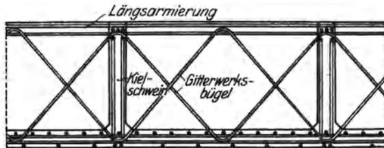
Abb. 35. Bodenwrangen. Eiseneinlagen mit einfachen Gitterwerksbügeln.
