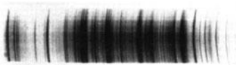
Bild 19. Spektralaufnahme eines Luftbogens im sichtbaren Gebiet. I = 900 A, p = 4 at, d = 1,9 mm, E_m = 150 V/cm.
